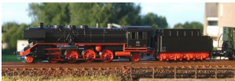
Norden – unangenehm auffallend die Sicherheitsventile, zu kleine Kuppelräder und die unmaßstäbliche Länge der Märklin-Lok 88092.
